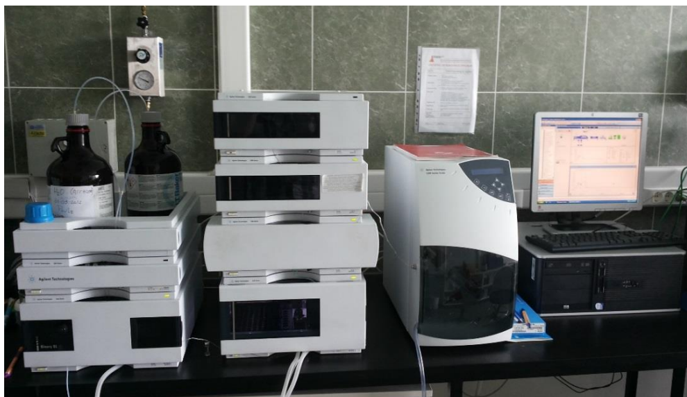
Slika 3.2. RP-HPLC-DAD-ELSD aparatura pomoću koje je izvedeno definisanje hromatografske lipofilnosti androstanskih derivata (Naučni institut za prehrambene tehnologije u Novom Sadu, FINS)
