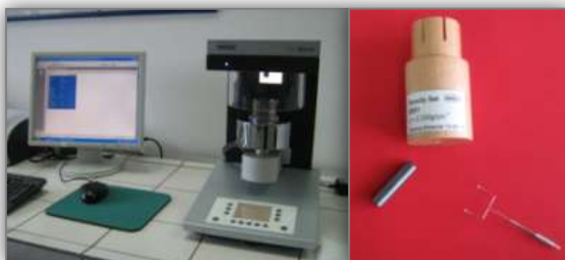
Slika 16. Gustinometar K20–Tensiometer EasyDyne i primenjeni pribor Density Set DE01
