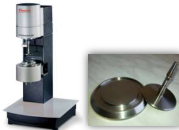
Slika 17. Rotacioni viskozimetar Haake Rheo Stress 600 i pribor PP60 Ti
