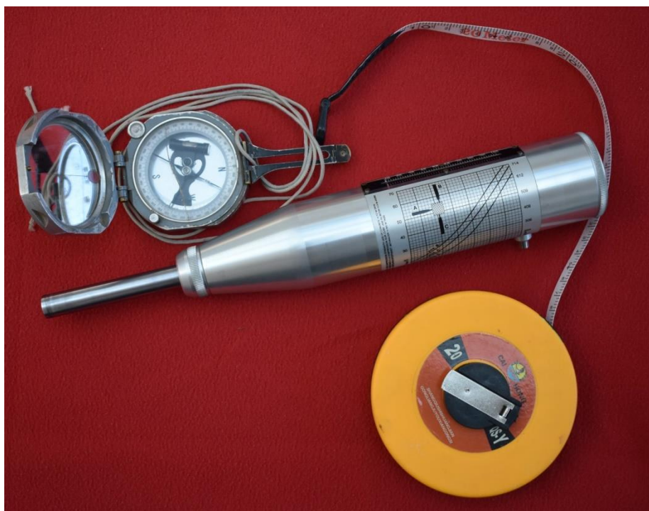
Прилог 4.3 - Шмит хамер тест чекић MATEST S.p.A., модел C380 и остала опрема за теренска истраживања (Фото: М. Буровић)
