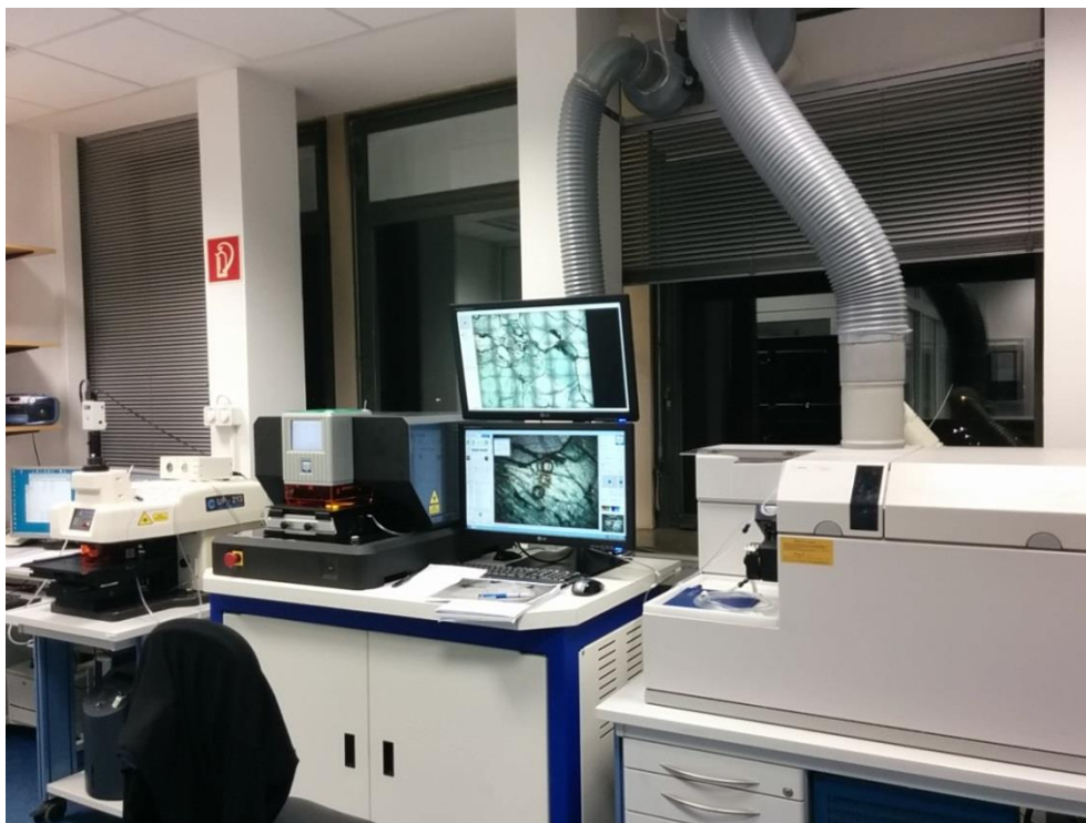
Slika 8. Instrument na kojem je vršeno određivanje koncentracije elemenata u tragovima u monokliničnom piroksenu iz ksenolita Jabal Eghei metodom laserske ablacije sa indukovano-spregnutom plazmom i masenom spektrometrijom (LA-ICP-MS) na Univerzitetu Johannes Gutenberg u Majncu, Nemačka.
