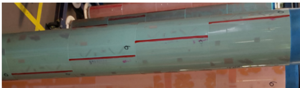
Slika 5.2.20: Štamparske forme montirane na smicanje
