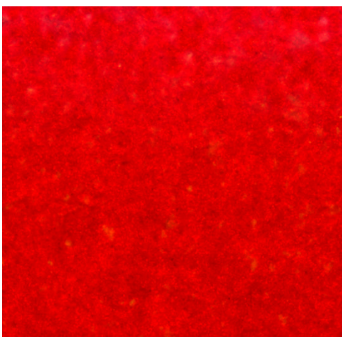
Slika 6.3.6: Snimak polja punog tona magenta boje štampanog pomoću 320x slivova na a) 1. rolni; b) 7. rolni
