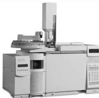
Slika 5.2.11: Agilent 6890 GC pećnica spojena sa 5975-N maseno selektivnim detektorom [Agilent, 2006]
