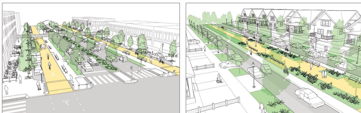
Slika 3.3 Šematski prikaz gradske saobraćajnice sa fizički odvojenim smerovima (NACTO, 2012)
