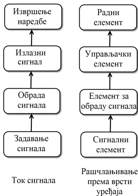
Слика 9. Ток сигнала у управљачком ланцу и елементи управљачког ланца [86]–[88]
