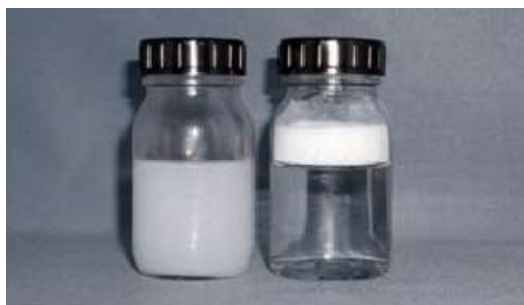
Slika 53. Vodena disperzija aerosol hidrofilnih (levo) i hidrofobnih (desno) nanočestica
