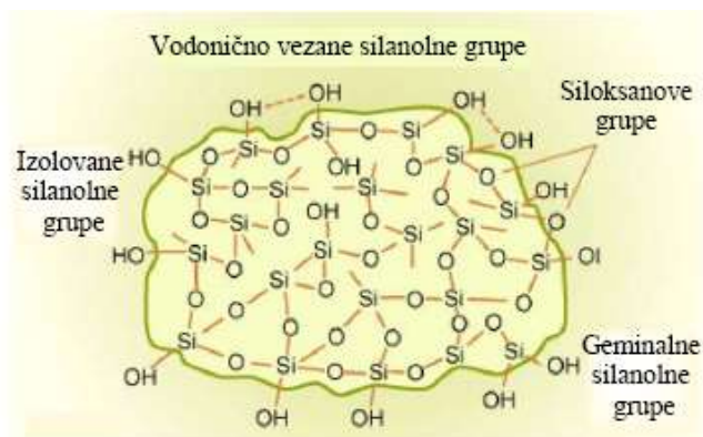
Slika 45. Reaktivne grupe na površini čestice punila \text{SiO}_2
