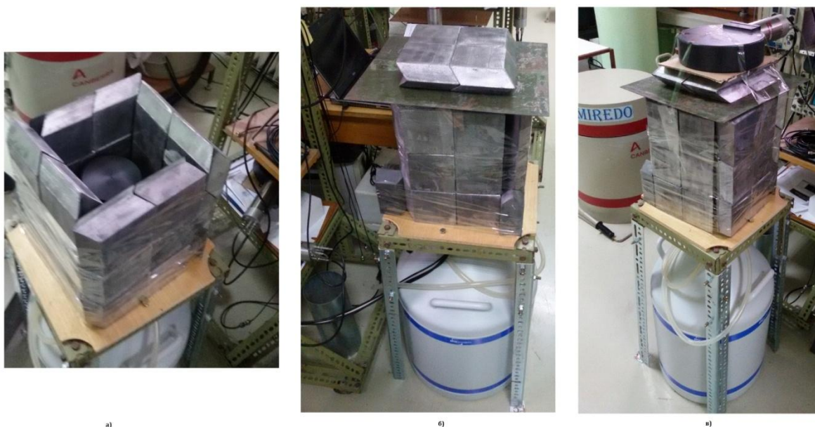
Слика 5.2 Коинцидентни детекторски систем постављен у лабораторији Департмана за физику у Новом Саду. Приказана је оловна заштита око HPGe детектора (а), оловна заштита око и изнад HPGe детектора (б), коинцидентни систем HPGe детектора и пластичног сцинтилационог детектора (в).
