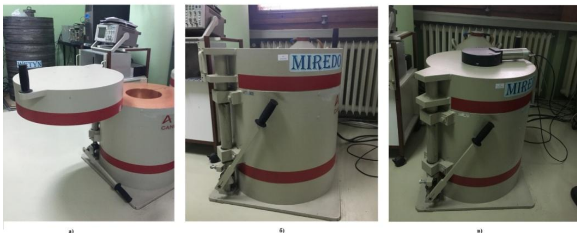
Слика 7.42 HPGe детектор (са интерном ознаком "B" детектор) (а) и (б) и експериментална поставка са пластичним сцинтилационим детектором (в).
