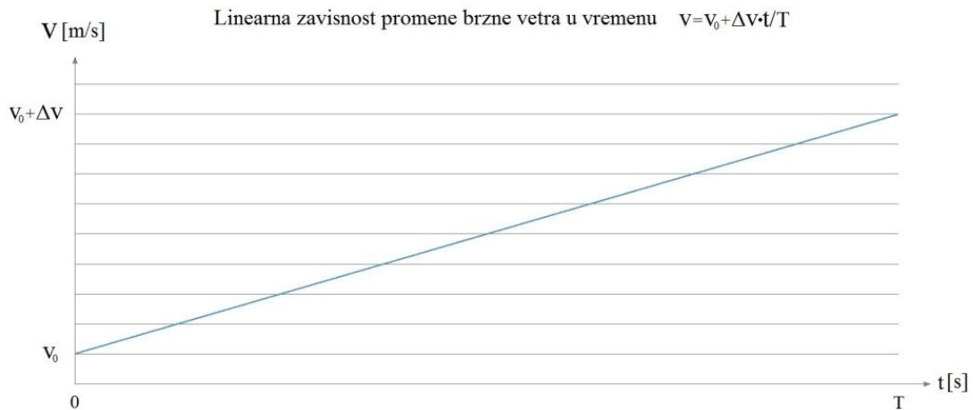
Slika 5.22. Prikaz linearne zavisnosti promene brzine vetra od v_0 do v_0 + \Delta v u vremenskom intervalu T
