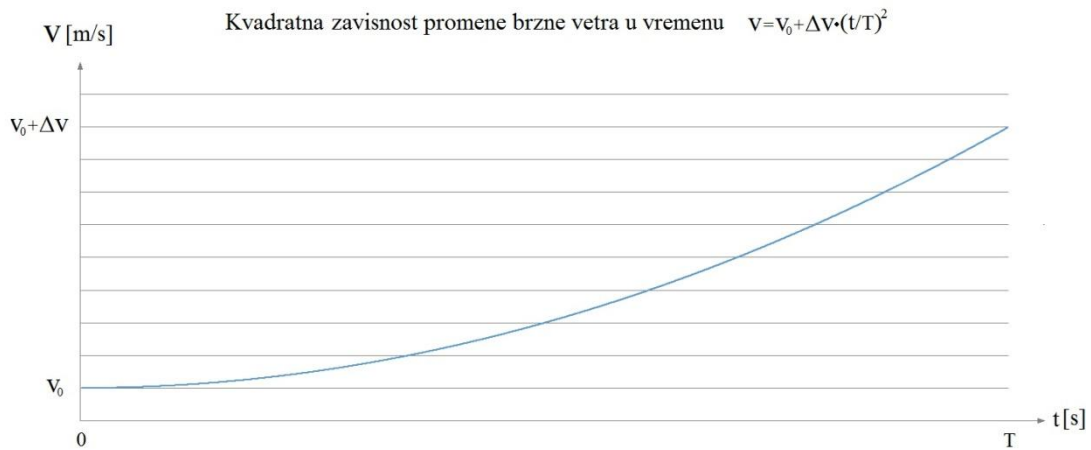
Slika 5.24. Prikaz kvadratne zavisnosti promene brzine vetra od v_0 do v_0 + \Delta v u vremenskom intervalu T
