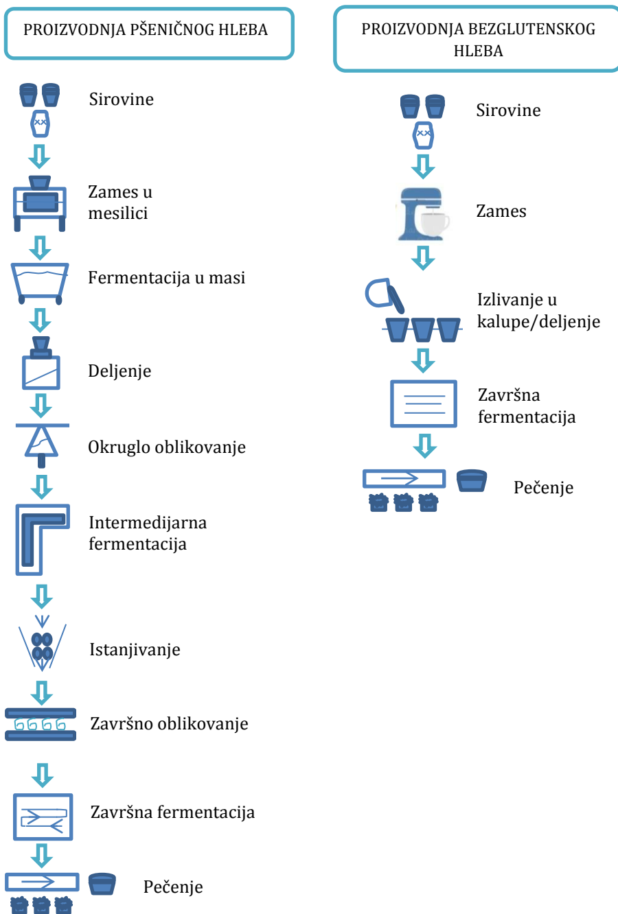
Slika 4. Šematski prikaz tehnoloških postupka proizvodnje pšeničnog i bezglutenskog hleba
