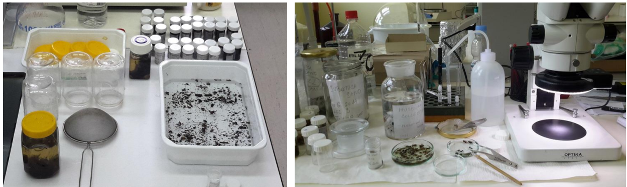
Slika 26. Ispiranje zamki i sortiranje materijala: terenska tegla sa materijalom u formalinu, kadica za ispiranje vodom, sortiran materijal u 70% etanolu. Determinacija materijala.
