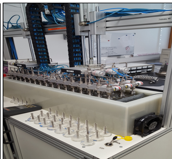
Slika 9. Šematski prikaz ekvilibracijske posude uronjene u vodeno kupatilo (lijevo, preuzeto od Mance, 2014) i u toku rada (desno)
