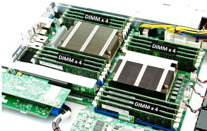
в) Supermicro X9DRW-CTF31 сервер (16x32GB ECC RDIMM)
