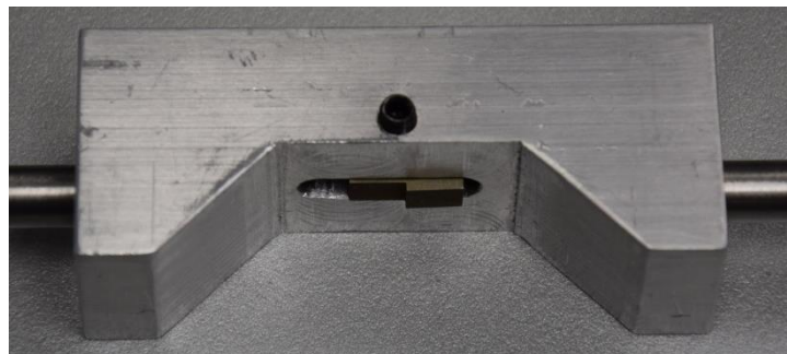
Слика 4.6 – Специјални резни алат (а) са носачем алата (б)
