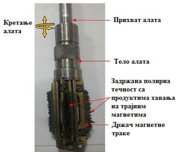
Слика 2.11 – Фотографија развијеног магнеторхеолошког алата за хоновање са задржаним MR флуидом за полирање [V. Grover (2017)]
