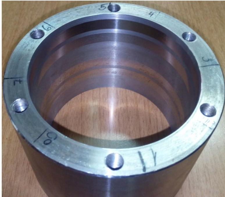
Слика 7.2 – Површина обрађена „ball burnishing“ поступком обраде
