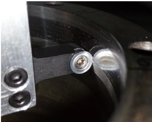
Слика 7.1 – Изглед обрађене површине након 50 пролаза развијеним алатом за микрорезање
