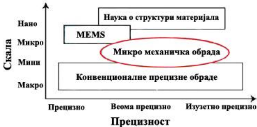
Слика 1.3 – Димензије компоненти у зависности од примењене микро-механичке обраде [J. Chae (2006)]
