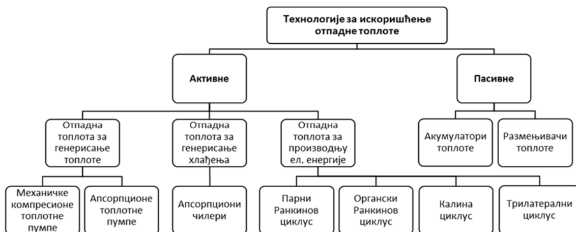
Слика 3.20. Категоризација технологија за искоришћење отпадне топлоте
