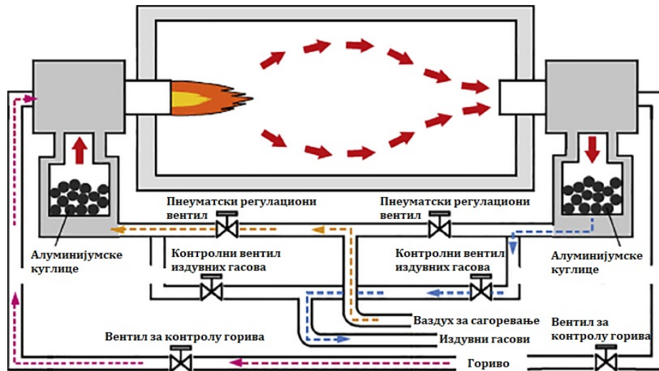
Слика 3.31. Принцип рада регенеративног горионика
