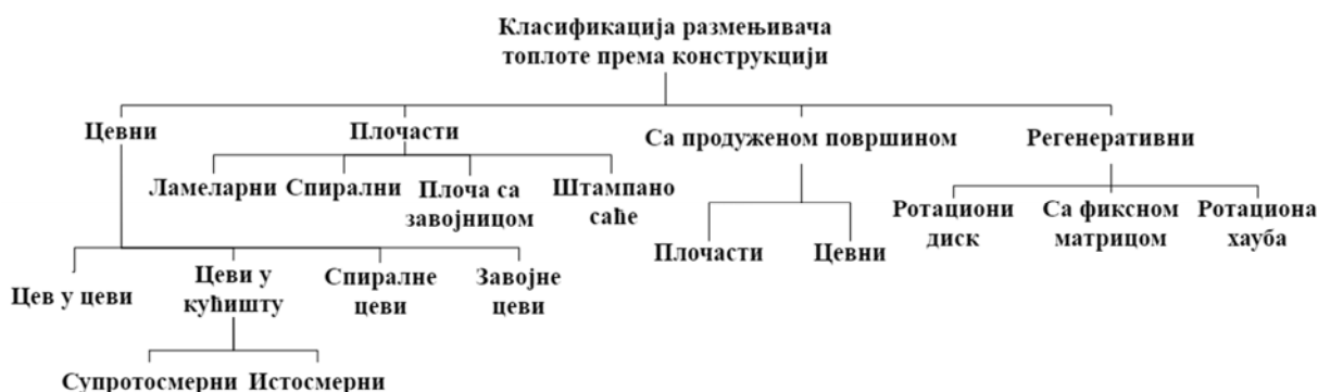
Слика 3.22. Класификација размењивача топлоте према конструкцији
