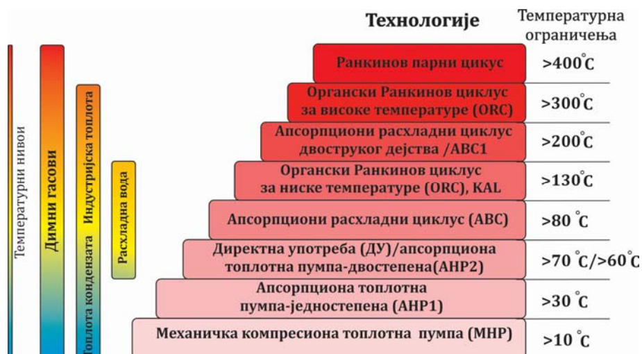
Слика 4.7. Технологије за искоришћење отпадне топлоте са опсезима температура
