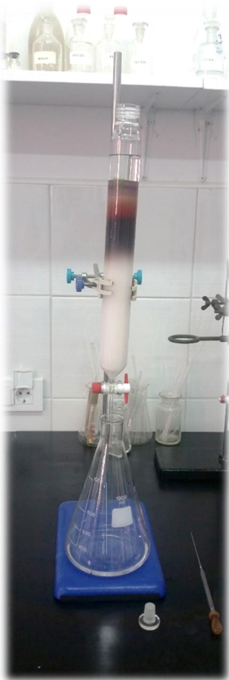
Слика 3.9. Пречишћавање добијених фракција применом стубне хроматографије на колони пуњеној Sephadex LH20
