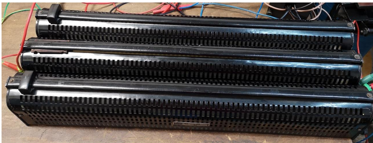
Сл. 6.4: Три једнофазна балансна отпорника везана у уземљену звезду
