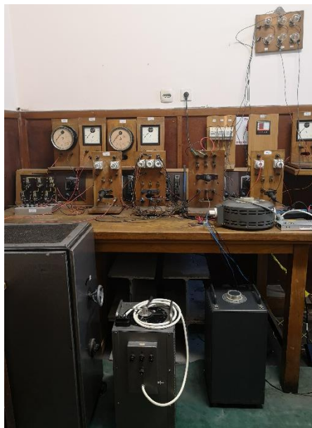
Сл. 6.11: Апаратура у лабораторији за иницијалну синхронизацију на мрежу и обезбеђивање рада генератора и мотора
