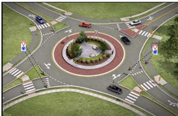
Slika 36. Regulisanje saobraćaja na kružnoj raskrsnici vertikalnom i horizontalnom signalizacijom [25]
