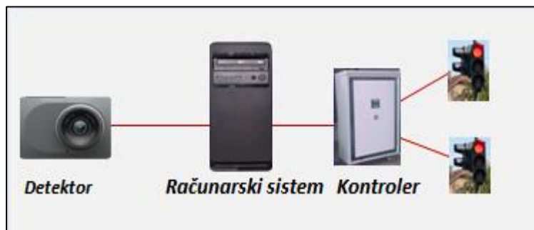
Slika 44. Šematski prikaz hardverske strukture adaptivnog sistema upravljanja saobraćajem
