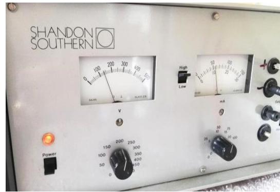
Slika 12. Ispravljač i tehnički uslovi elektroforetskog razdvajanja proteina (originalna fotografija)
