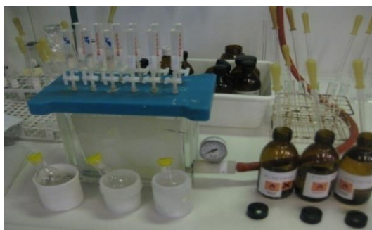
Slika 34. Manifold za SPE kertridže sa rastvaračima za eluiranje analita
