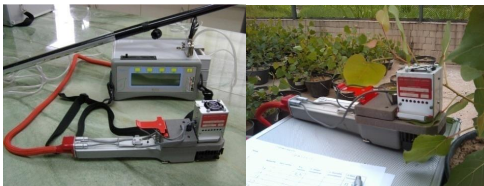
Slika 58. Instrument za merenje razmene gasove i parametara fotosinteze (Lpro+)
