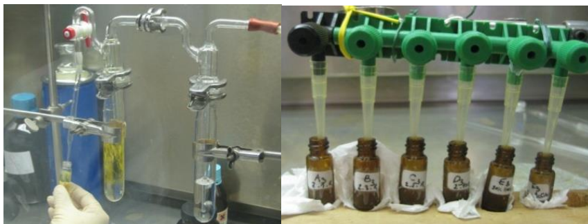
Slika 36. Aparatura za sintezu diazometana (levo) i uparavanje uzoraka sa diazometanom u struji azota nakon derivatizacije
