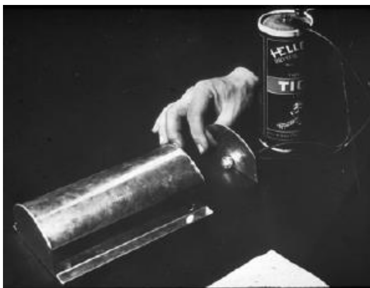
Slika 2.4. Optički model hale sa konkavnom tavanicom [Rindel, 2002].
