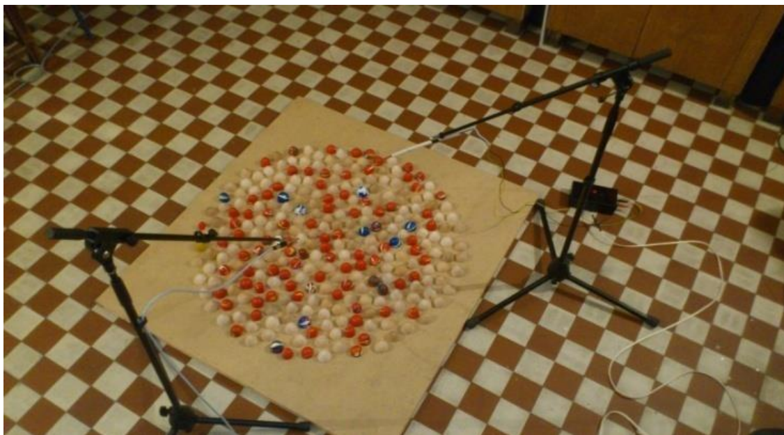
Slika 7.2. Postavka eksperimenta u slučaju kada je čitava površina prekrivena kalotama.
