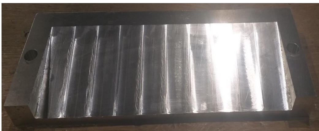
Slika 9.22 Pripremak od Al7075 za eksperimentalno ispitivanje samopobudnih vibracija
