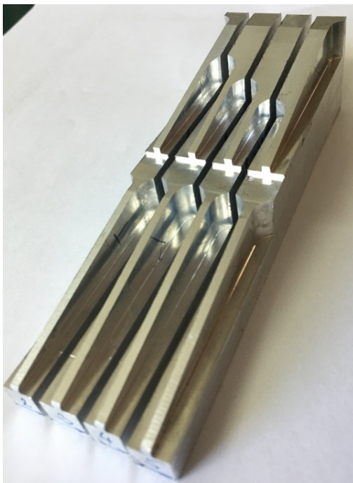
Slika 9.30 Izdvojeni uzorci za analizu hrapavosti obrađene površine
