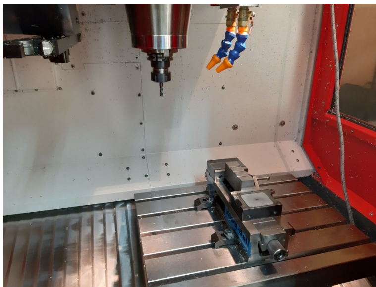
Slika 9.44 Priprema obradnog centra EMCO ConceptMill 450 za eksperimentalna ispitivanja
