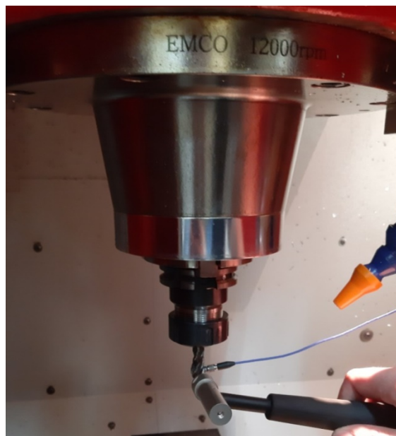
Slika 9.3 Procedura eksperimentalne modalne analize obradnog centra EMCO-2
