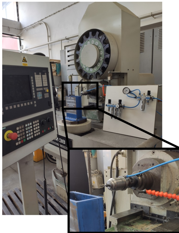
Slika 10.1 Pneumatsko vreteno za mikroobradu stegnuto u glavno vreteno obradnog centra FM-38
