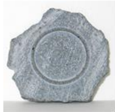
Слика 3. 5 Узорак базалта након озрачивања TEA CO 2 ласером
