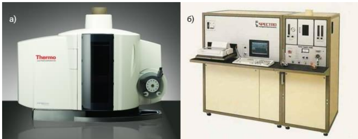
Слика 3. 10 ICP-OES инструменти коришћени у оквиру ове дисертације: а) Thermo iCAP 6500 ; б) Spectroflame . (слике преузете са [75,76] )
