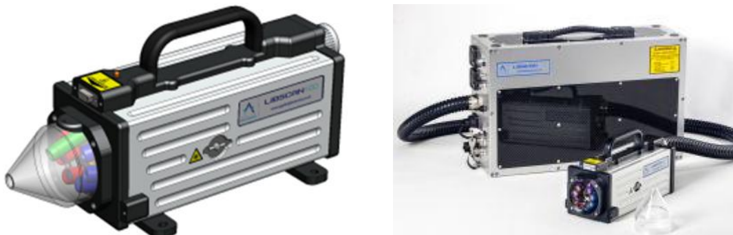
Слика 3. 4 LIBSCAN-100 LIBS систем са Nd:YAG ласером: а) LIBSCAN глава са 8 спектралних канала, б) LIBSCAN конзола (преузето са [73] )
