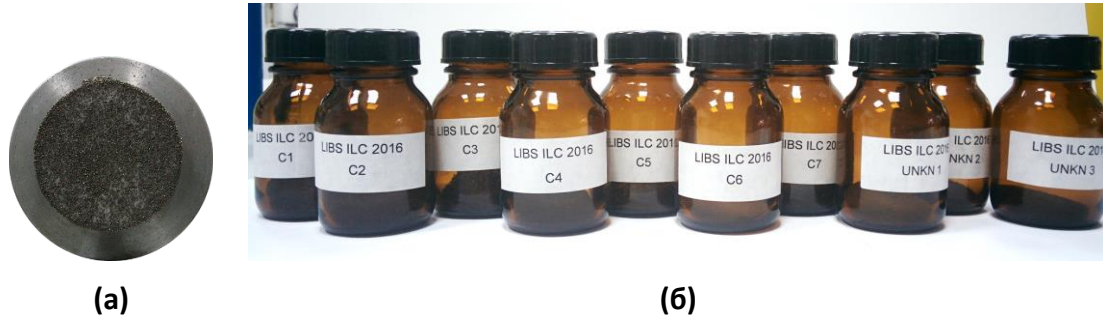
Слика 3. 8 Узорци ливеног гвожђа: а) узорак фиксиран на алуминијумски носач; б) сет од десет узорака ливеног гвожђа
