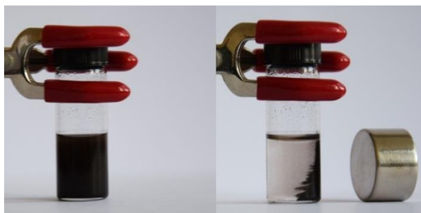
Slika 24. Odvajanje katalizatora iz reakcione smeše upotrebom eksternog magneta.
