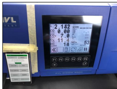
Слика 3.2. Уређај за мерење емисије издувних гасова са апликацијом за мерење брзине
