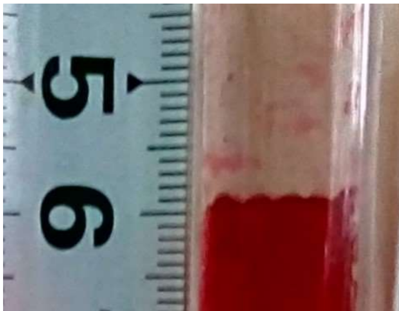
Slika 3.21. Primer uvećane fotografije napravljene mobilnim telefonom sa koje se očitavala vrednost \Delta h .
