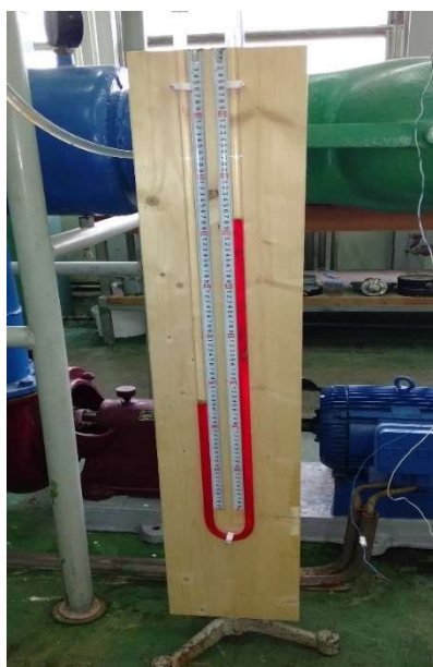
Slika 3.17. Fotografija diferencijalnog "U" manometra specijalno projektovanog i napravljenog za merenje malih razlika pritisaaka.
