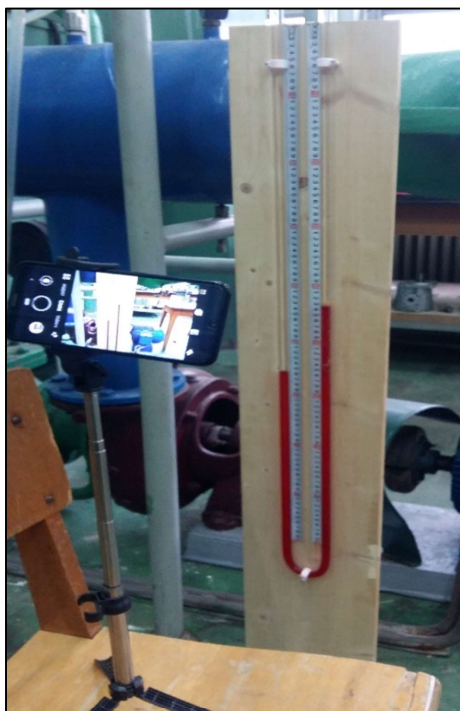
Slika 3.19. Način fotografisanja razlika nivoa stubova radne tečnosti pomoću mobilnog telefona i stalka.
