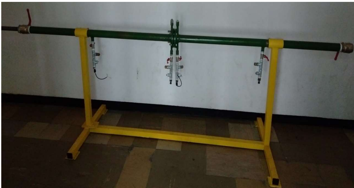
Slika 3.15. Fotografija laboratorijske aparature na kojoj su ispitivane merne blende.
