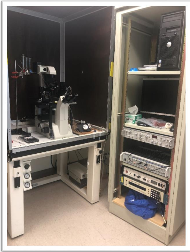
Slika 16. Fotografija aparature korišćene za metodu nametnute voltaže koju smo koristili za snimanje promena u biofizičkim karakteristikama kalcijumovih kanala na disociranim telima senzornih neurona. Levo je prikazan invertni fluorescentni mikroskop Nikon za mikroskopiranje ćelija. Desno su prikazani pojačivač signala AxoPatch 200B, Digidata 1440A i kontrolor manipulatora Sutter Instruments (odozgo na dole).
