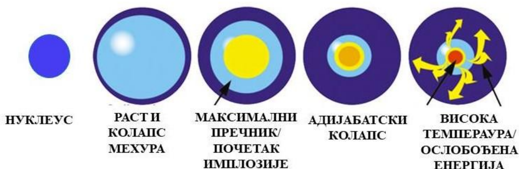
Слика 2.11 Механизам развоја кавитације [66]
