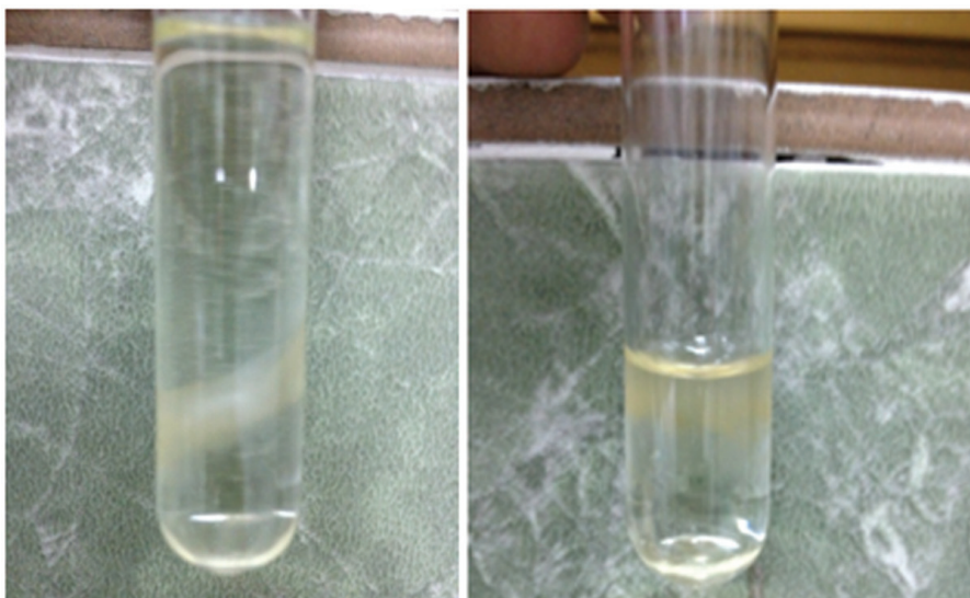
Slika 3.9. Razdvajanje faza nakon centrifugiranja primenom DLLME tehnike
