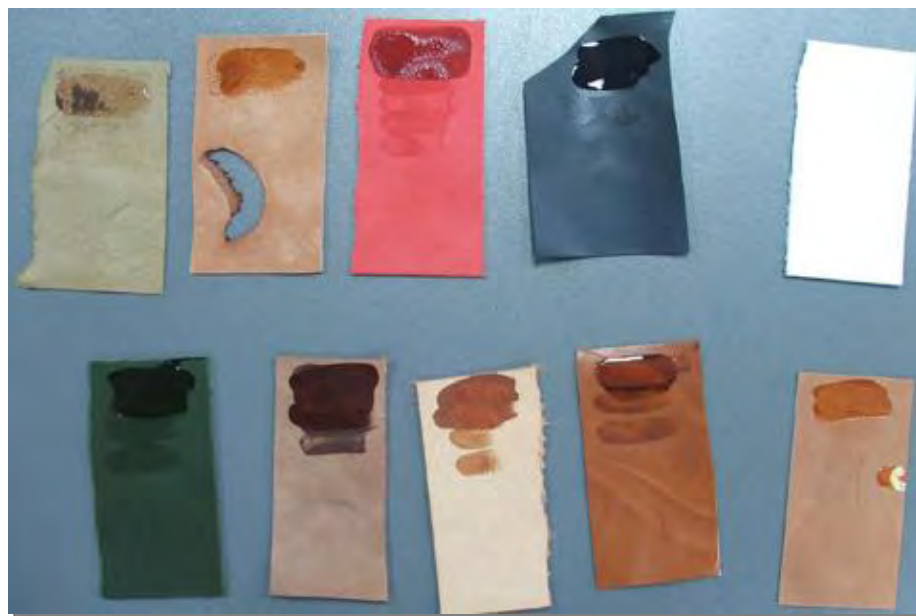
Сл. 24. Наношење филма у два слоју
