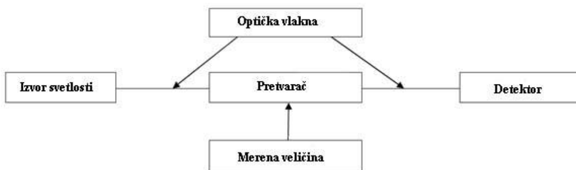
Slika 5.1. Princip rad senzora sa optičkim vlaknima [79]
