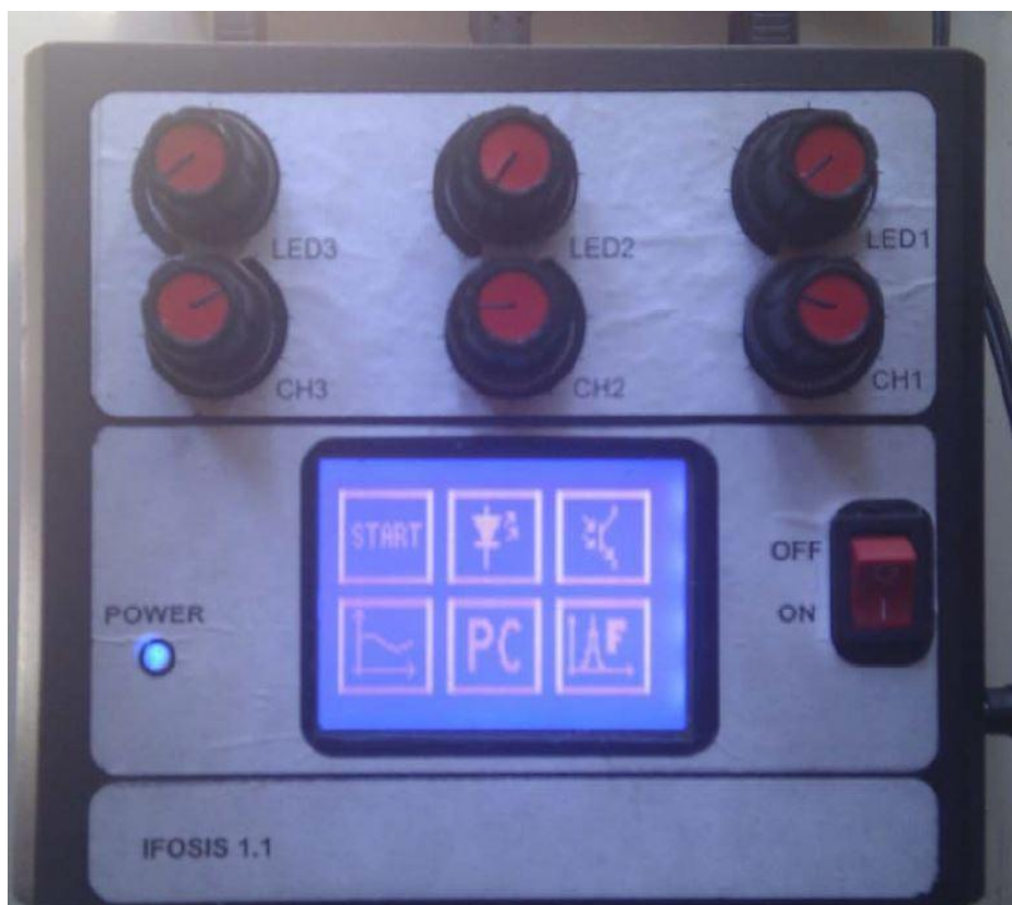
Slika 7.15. Laboratorijski prototip KFOS i displej u početnom modu [155]
