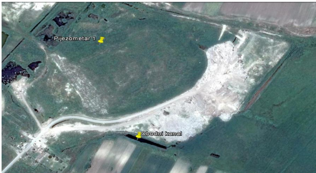
Slika 7.7. Satelitski snimak lokaliteta deponije i mesta uzorkovanja podzemne vode iz bunara (pijezometra) i procedne vode iz obodnog kanala.
