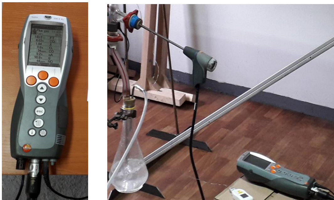
Slika 5.15. Fotografski izgled gasnog analizatora Testo 330-2 LL (pojedinačno i u konekciji sa drugim elementima eksperimentalnog postrojenja)
