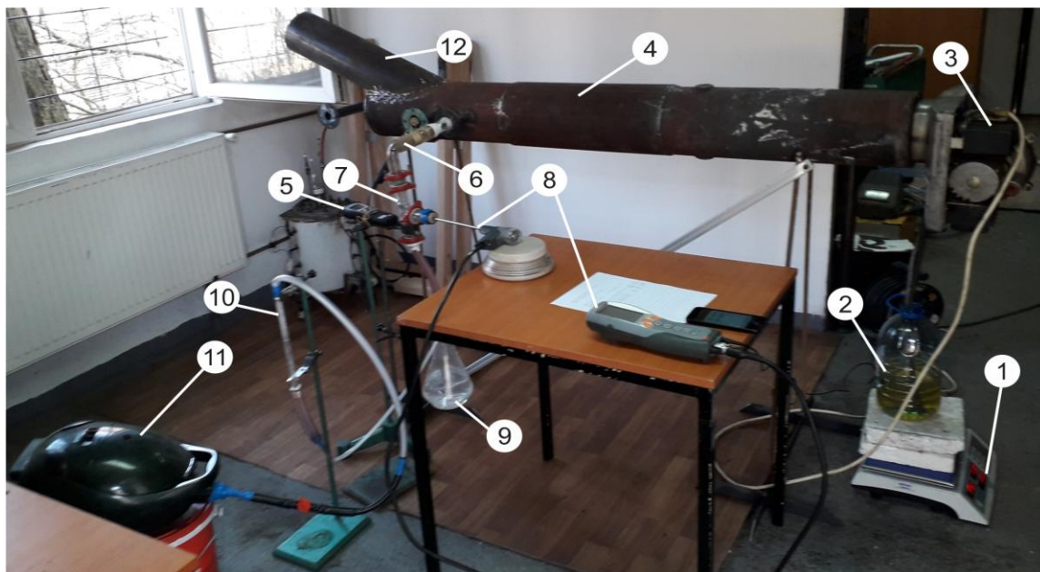
Slika 5.16. Fotografski izgled laboratorijskog postrojenja za ispitivanje parametara sagorevanja i emisije OTU, OMU i njihovih dizel mešavina 1-vaga za merenje potrošnje goriva, 2-posuda za tečno gorivo, 3-gorionik, 4-rotaciona peć, 5-pokazivač temperature, 6-vod parcijalne struje dimnih gasova, 7-posuda za analizu dimnih gasova, 8-analizator dimnih gasova, 9-posuda za pranje dimnih gasova, 10-mjerač protoka dimnih gasova, 11- pumpa, 12-dimni kanal
