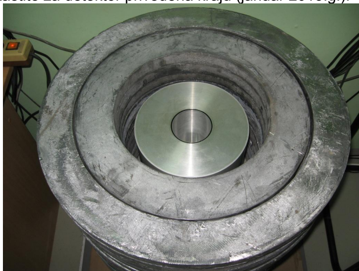
slika 120 - završetak postavljanja olovnih segmenata oko detektora
