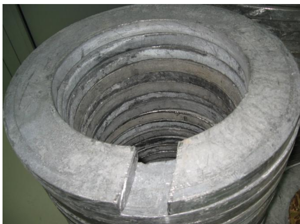
slika 112 - isečeni delovi olovnih prstenova za sprovođenje kablova
