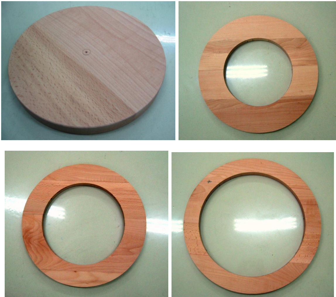
slika 108 - krug ispod detektora, prstenovi oko detektora i spoljašnji prsten oko celog unutrašnjeg olovnog cilindra
