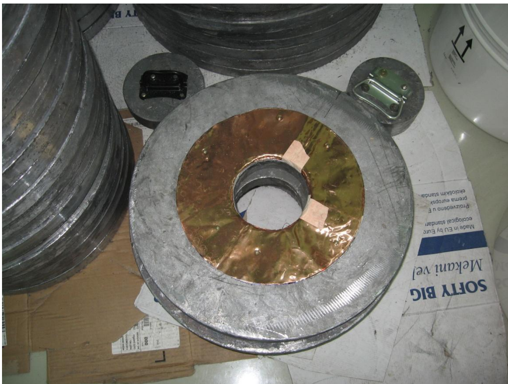
slika 111 - montiranje kalajnog i bakarnog lima na gornji olovni deo iznad detektora
