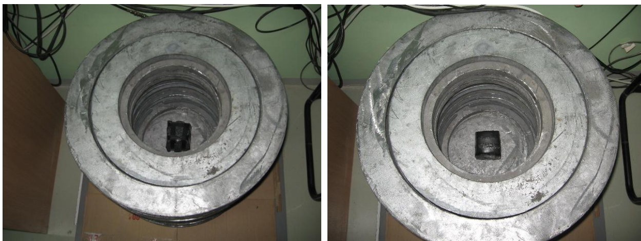
slika 117 - donji prstenovi oko fotomultiplikatora imaju za 4 cm manji prečnik otvora nego prstenovi oko Nal(Tl) - ovakav sklop je omogućio da ti prstenovi posluže i kao nosači celog detektorskog sistema
