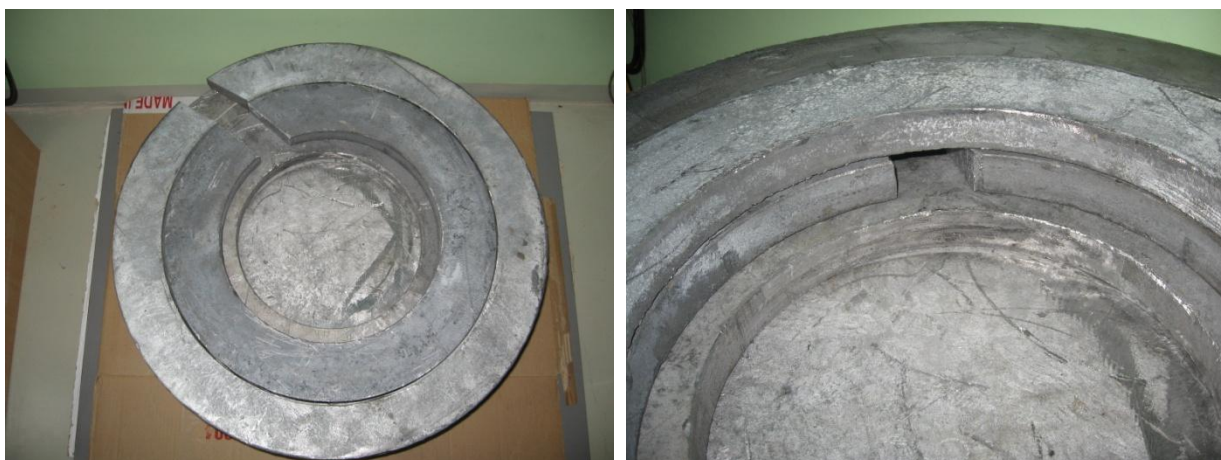
slika 116 - otvor za sprovođenje kablova
