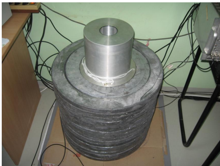
slika 119 - 9``x 9`` NaI(Tl) detektor sa spuštenim fotomultiplikatorima u olovo
