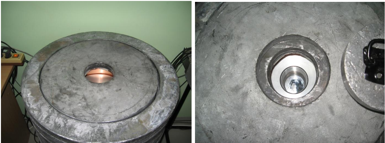
slika 122 - postavljanje olovnih delova iznad detektora
