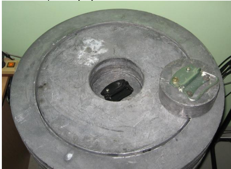
slika 123 - izgled otvora sa poklopcima za promenu uzoraka
