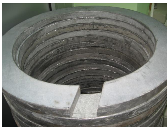
slika 112 - isečeni delovi olovnih prstenova za sprovođenje kablova
