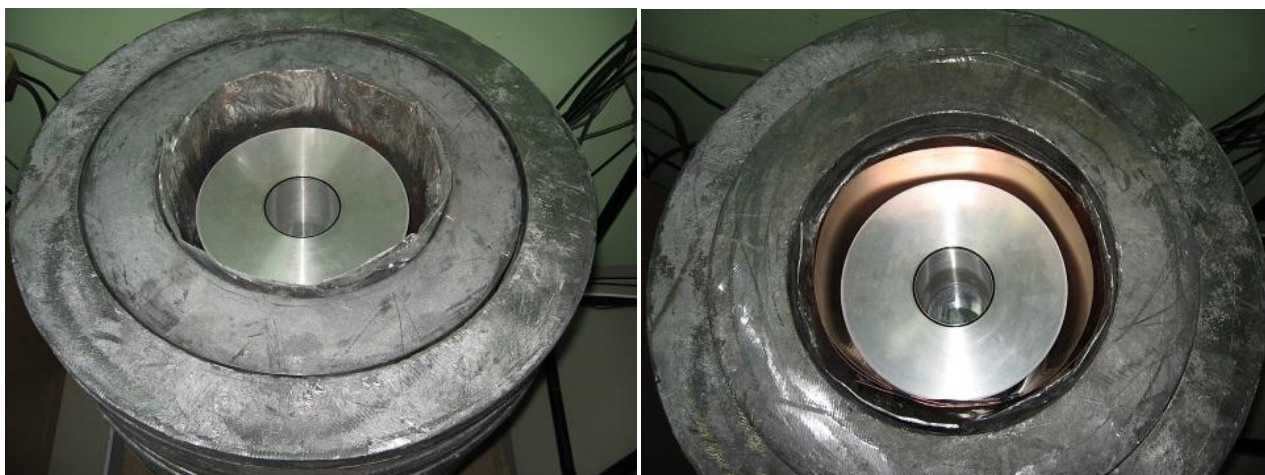
slika 73 i 74 - postavljeni limovi od Sn i od Cu oko 9'' x 9'' NaI(Tl)
