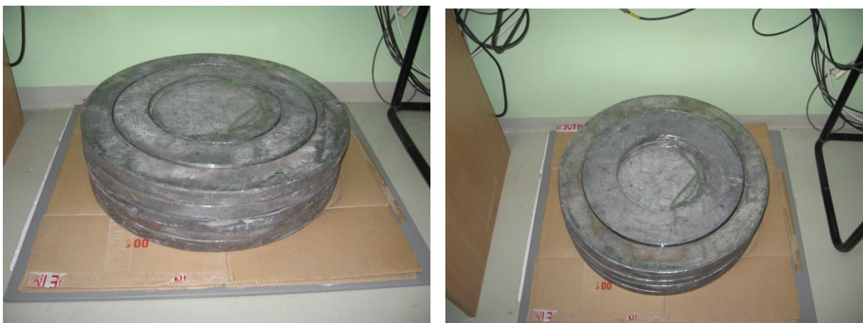
slika 115 - olovni delovi ispod detektora
