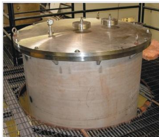
slika 32b - peć za proizvodnju kristala
