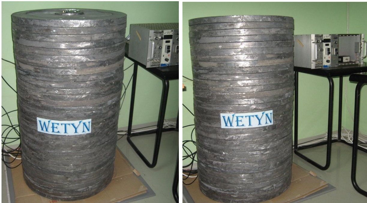
slika 124 - sastavljena olovna zaštita za 9``x 9`` NaI(Tl) detektor sa pripadajućim elektronskim komponentama
