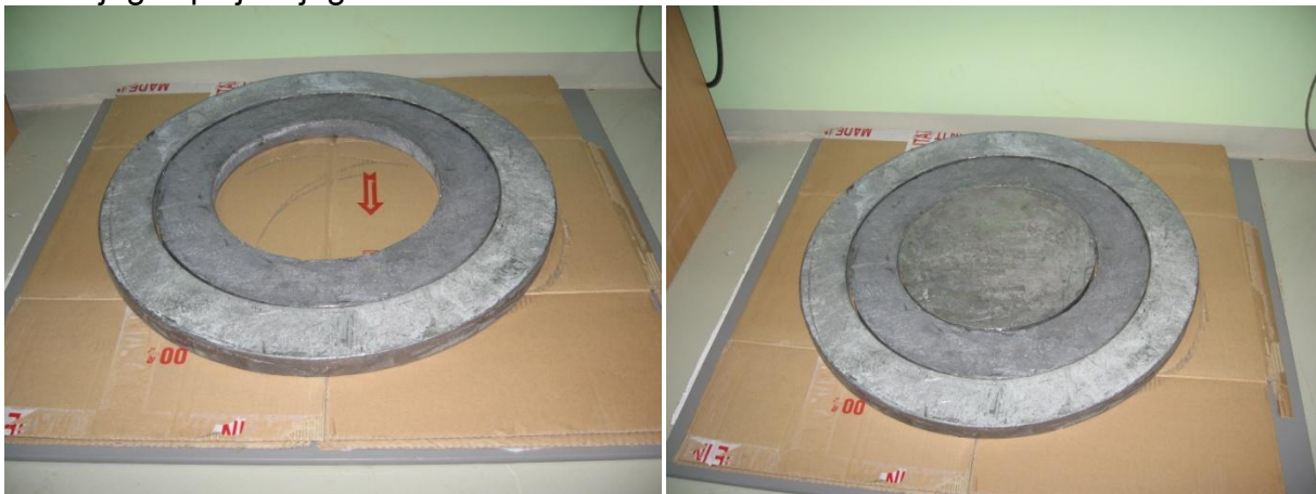
slika 114 - kartoni i gvozdena ploča ispod olovne zaštite
