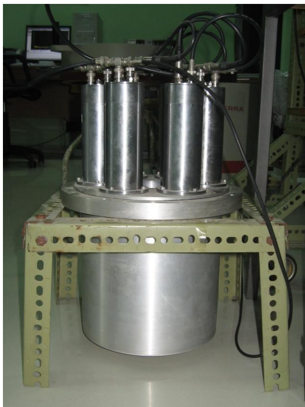
slika 80 - 9`` x 9`` NaI(Tl) detektor okrenut fotomultiplikatorima gore
