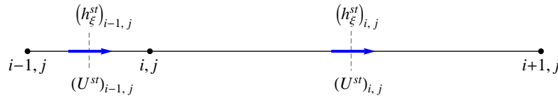
Slika 22: Određivanje jediničnih protoka u glavnim tačkama računске mreže
