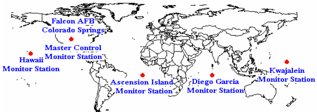
Слика 4. Главне контролне тачке ГПС-а
