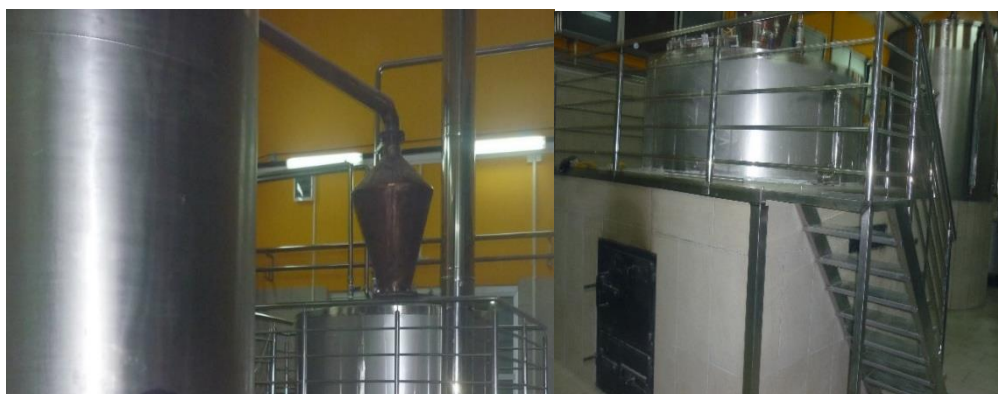
Fotografija 27. Uređaj za destilaciju (kazan-ložište za drova) zapremine 2500 litara
