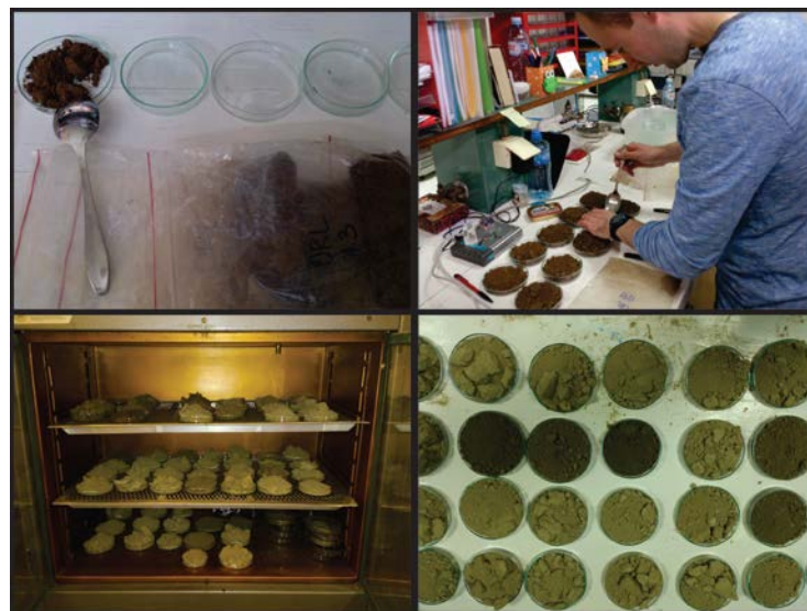
Прилог 21. Припрема узорака за лабораторијско одређивање боје у влажном и сувом стању (Фото: Т. Лукић)
