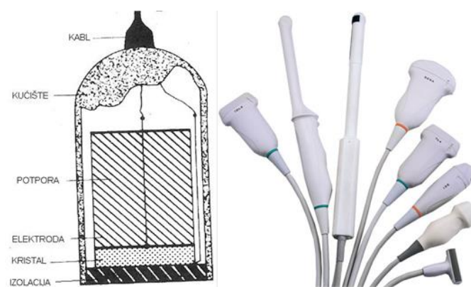
Slika 2.1.2.1.: Delovi ultrazvučne sonde i različiti tipovi ultrazvučnih sondi.
