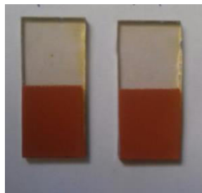
Slika 49. Primer odštampanih fotoanoda (levo – uzorak 1:1 Fe 2 O 3 /TiO 2 , desno – 1:1,5 Fe 2 O 3 /TiO 2 )
