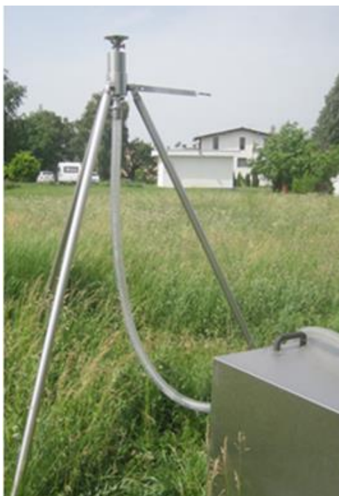
Slika 8. Merno mesto – kaskadni impaktor niskog pritiska Prof. Dr. Berner – LPI 25/0,0085/2
