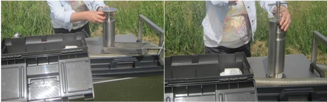
Slika 9. Postavljanje impaktora u presu radi transporta u laboratoriju
