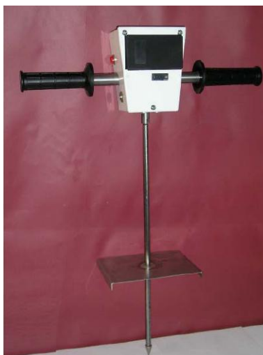
Sl. 39. Originalno rešenje vertikalnog ručnog penetrometra (Bajla et al., 2012)
