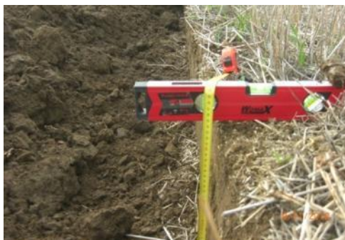
Sl. 62. Merenje dubine obrade raonog pluga
