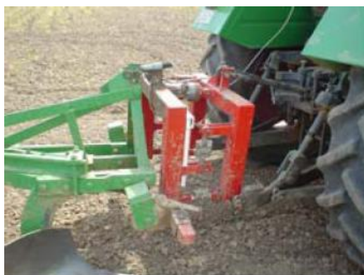
Sl. 34. Konstrukcija dvostrukog "II" mernog rama
