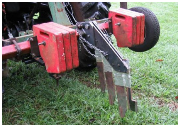
Sl. 22. Merni sistem sa više vertikalnih tela različitih dužina
