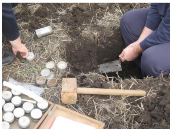
Sl. 63. Postupak uzimanja uzoraka zemljišta u neporemećenom stanju u cilju određivanja zapreminske mase i trenutne vlažnosti.
