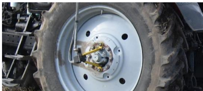
Sl. 59. Enkoder postavljen na naplatak zadnjeg točka traktora tokom poljskog testa
