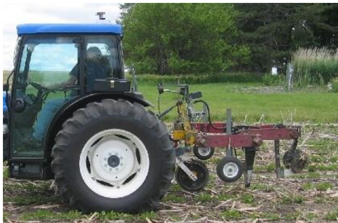
Sl. 25. Integrisani sistem za mapiranje fizičkih karakteristika zemljišta
