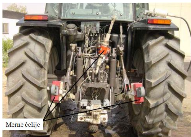
Sl. 35. Merni sistem instaliran na priključnim polugama hidrauličnog podizača traktora MF3090
