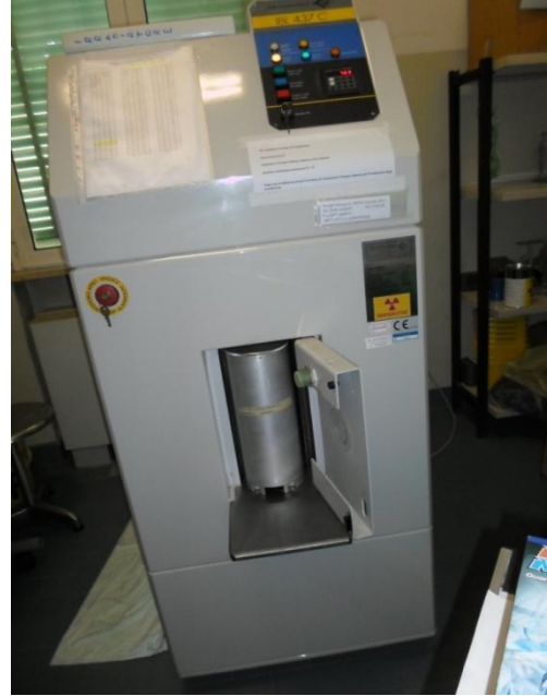
Сл. 106 IBL 437 ирадијатор (са линеарним извором зрачења ^{137}\text{Cs} ) у кога је интродукован цилиндар са луткама мужјака које ће бити подвргнуте ирадијацији од 30 Gy (Оригинал)
