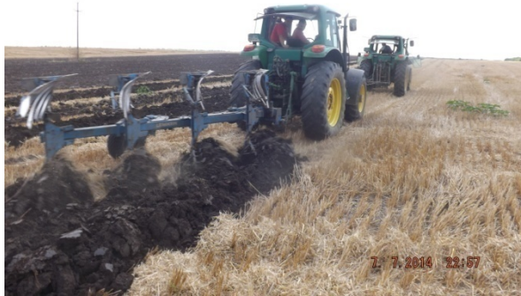
Slika 5.3. Simulacija opterećenja pomoću drugog traktora agregiranog plugom
