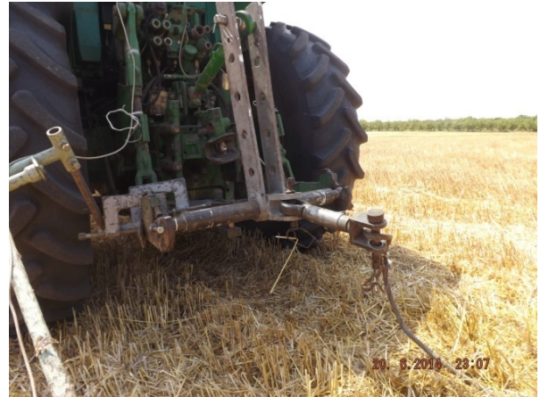
Slika 5.4. Dinamometar, povezan sa poteznicom i sajlom
