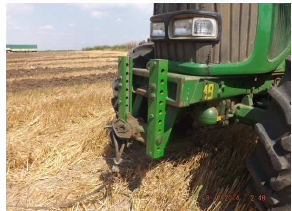
Slika 5.8. Specijalna poteznica za održavanje horizontalne linije vuče
