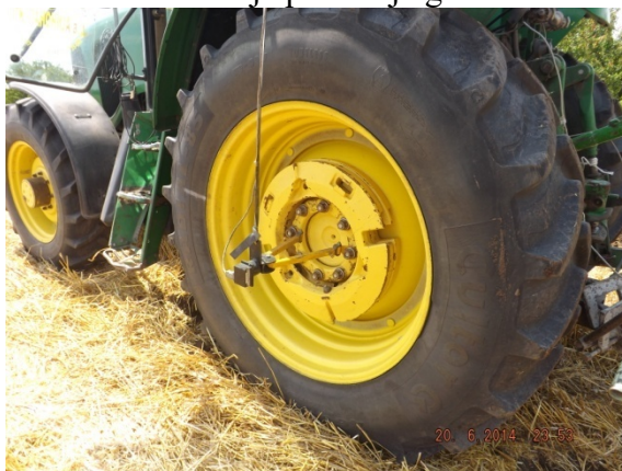
Slika 5.7. Davač broja obrtaja pogonskog točka traktora
