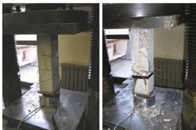
Slika 4.55. Uzorak sa digitalnim dinamometrom pre i posle ispitivanja [33]
