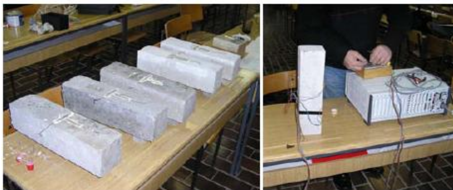
Slika 4.54. Uzorci za ispitivanje modula elastičnosti i Poisson-ovog koeficijenta i uzorak spojen na digitalni merni most [33]
