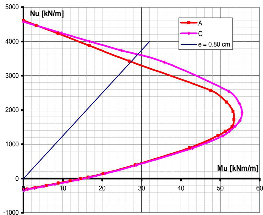
Slika 5.61. Dijagram interakcije ploče poliedarske ljuške u čvrnoj liniji 1 u preseku y=10\text{m} za RDA radni dijagram betona sa e_{bu}=-3.5\% i RDA dijagram čelika (slika gore) i njegov uporedni prikaz sa dijagramom prema EC 2 (slika dole)
