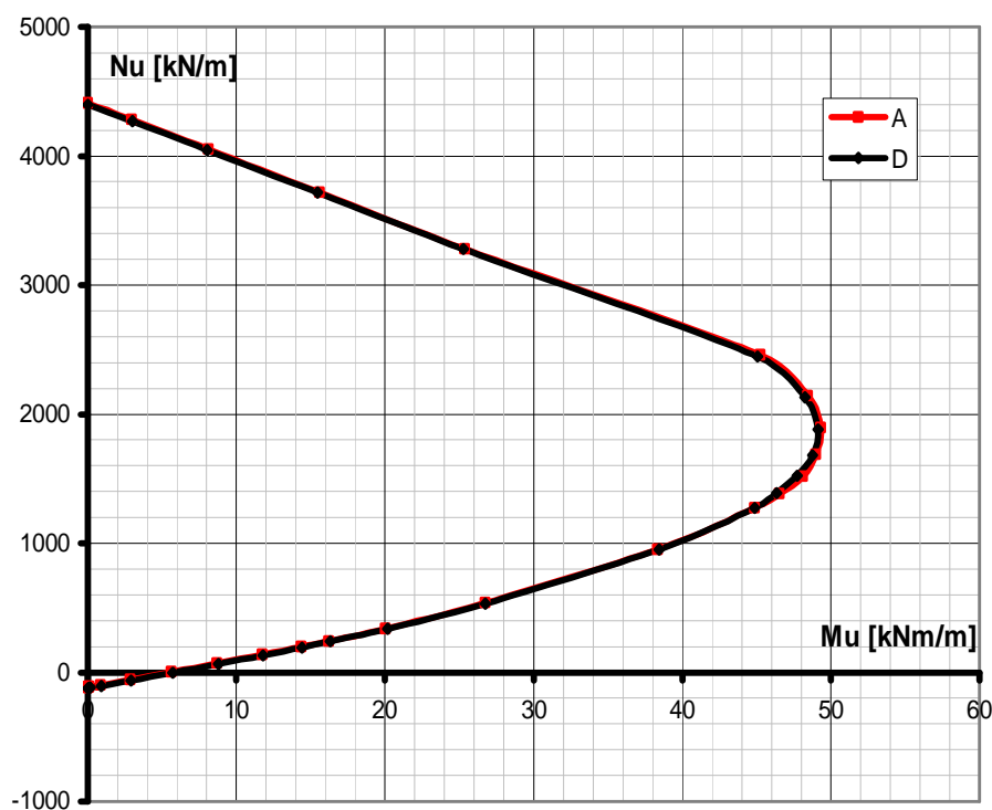
Slika 5.71. Dijagram interakcije ploče poliedarske ljuške u čvrnoj liniji 8 u preseku y=10\text{m} za radni dijagram betona prema EC 2 i RDA dijagram čelika (slika gore) i njegov uporedni prikaz sa dijagramom prema EC 2 (slika dole)
