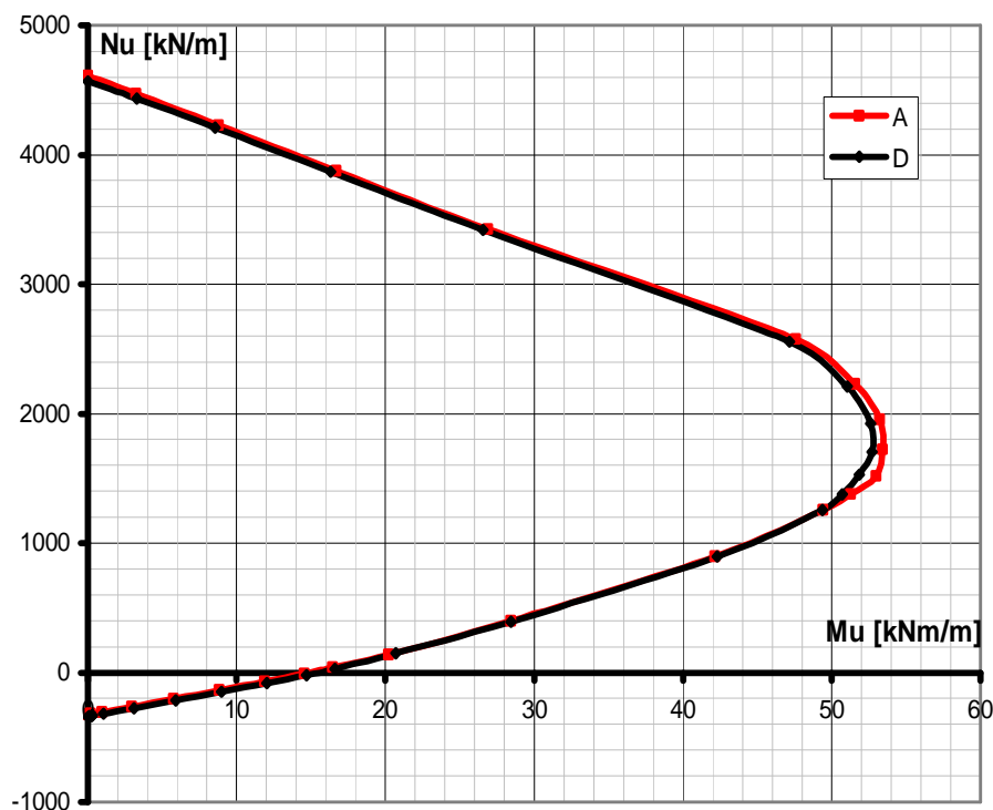
Slika 5.62. Dijagram interakcije ploče poliedarske ljustke u čvornoj liniji 1 u preseku y=10\text{m} za radni dijagram betona prema EC 2 i RDA dijagram čelika (slika gore) i njegov uporedni prikaz sa dijagramom prema EC 2 (slika dole)
