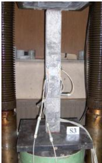
Slika 4.50. Dispozicija uzorka i mernih uređaja [66]
