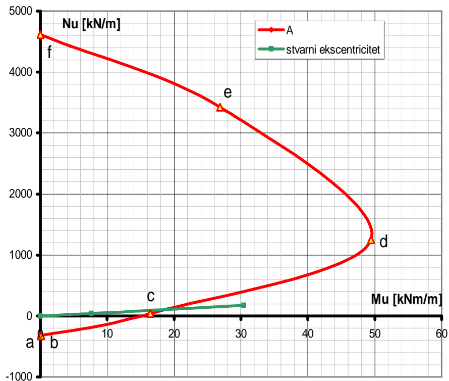
Slika 5.65. Dijagram interakcije ploče poliedarske ljuške u čvornoj liniji 1 u preseku y=10\text{m} za radne dijagrame betona i čelika prema EC 2
