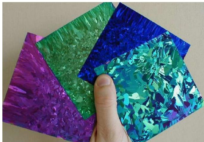
Slika 5. Polikristalne celije pokrivenе antirefleksivnim slojem silicijum-nitrida ( $Si_3N_4$ ) različite debljine. Boja zavisi od debljine antirefleksivnog premaza.
