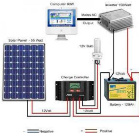
Slika 49. Jednostavan sistem koji ilustruje ideju solarnih čelija na integriran način
