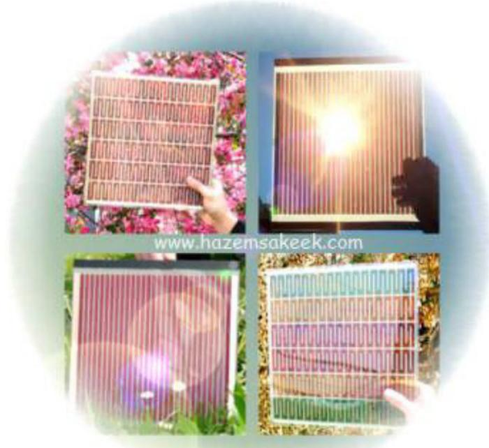
Slika 40. Skup solarne pigmentne čelije
