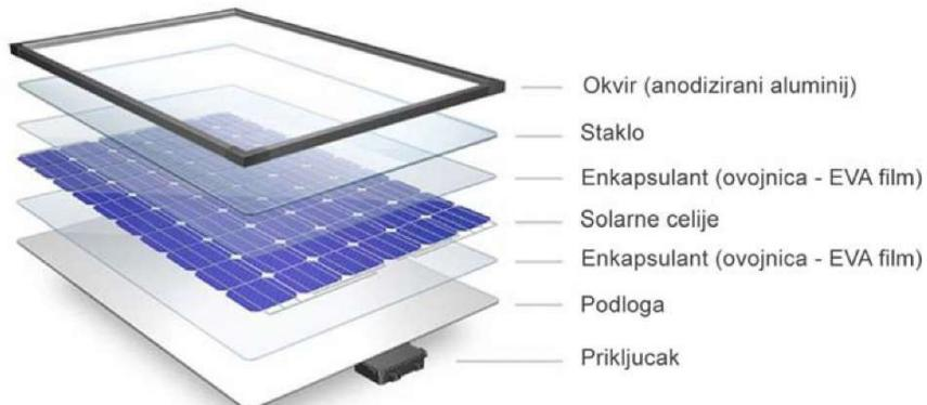
*Slika 7. Sastavni delovi solarnog fotonaponskog modula*
