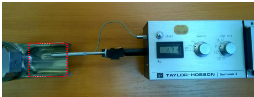
Слика 9.23. Мерење површинске хравности клипњаче
