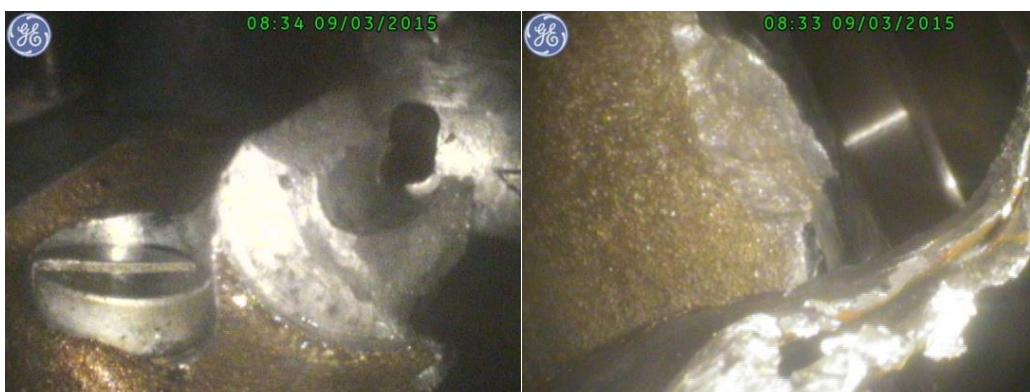
Слика 5.2. Унутрашњост радног простора хаварисаног мотора тенка М-84
