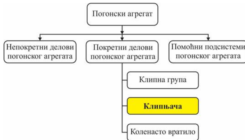
Слика 9.8. Шема приказа позиције клипњаче у структури погонског агрегата
