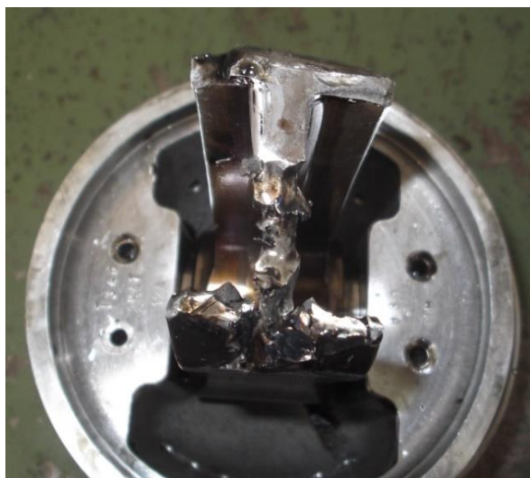
Слика 9.13. Клип са делом поломљене клипњаче
