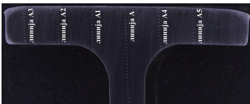
Слика 9.28. Линије узорка на којим је извршено мерење микротврдоће клипњаче
