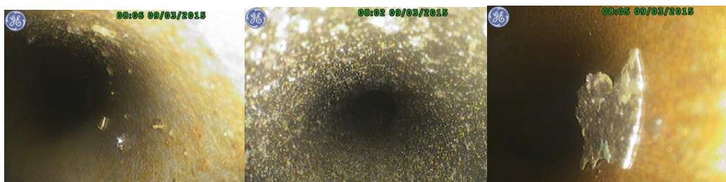
Слика 5.4. Унутрашњост цевовода система за довод горива тенка М-84А
