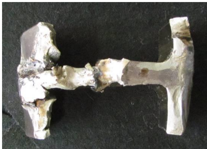
Слика 9.20. Механичко оштећење површине лома клипњаче
