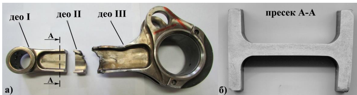
Слика 9.19. (а) Поломљена клипњача (б) Металографски узорак за макроструктурно испитивање (пресек А-А)
