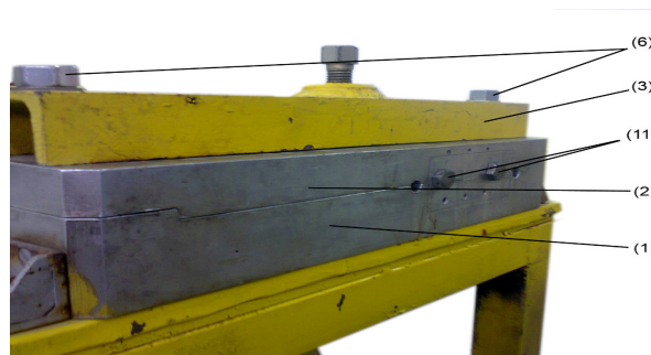
Слика 5.6 – Алат за израду тела лопатице репног ротора – (поглед В)
