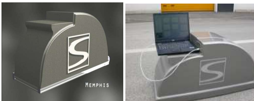
Слика 32. Мобилни рефлектометар Memphis друге генерације
