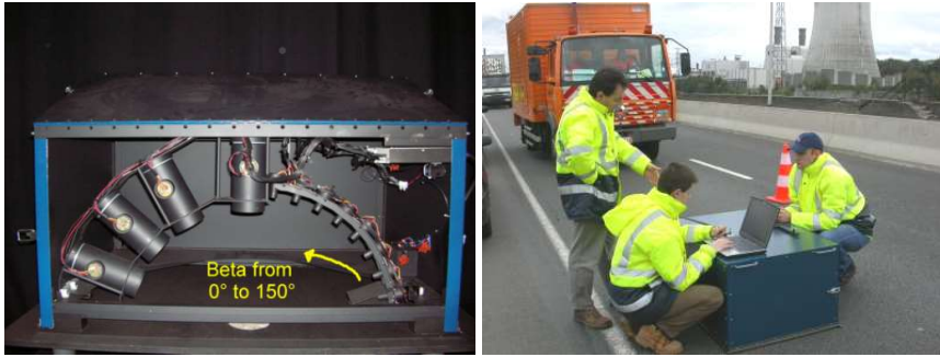
Слика 30. Мобилни рефлектометар Memphis прве генерације (прототип)
