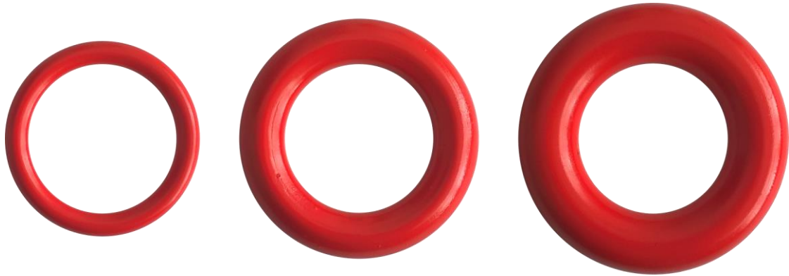
Слика 6.17 Разматрани уводници у експерименталним испитивањима Разматрана су три уводника различитих полупречника усница: r_k = 0.15R (лево), r_k = 0.3R (средина) и r_k = 0.4R (десно).
