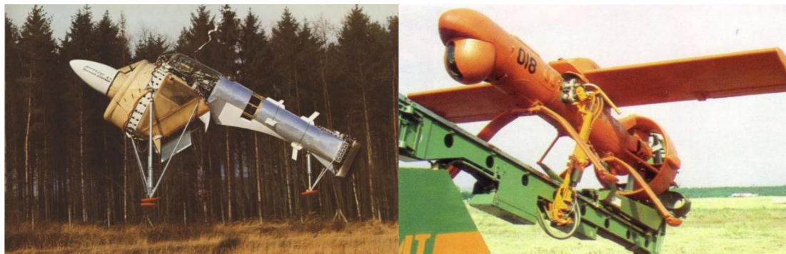
Слика 1.19 Беспилотне летелице са каналисаним пропулзором Dornier Aerodyne (лево), Пчела 1 (десно).
