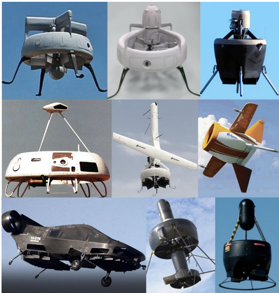
Слика 1.20 Беспилотне VTOL летелице са каналисаним пропулзором ASIО-B (горе лево), Spyball-B (горе средина), GoldenEye 80 (горе десно), Surpher (средина лево), V-BAT (средина средина), GoldenEye 50 (средина десно), Air Mule (доле лево), STAero FanTail (доле средина), BAЕ IAV1 (доле десно).
