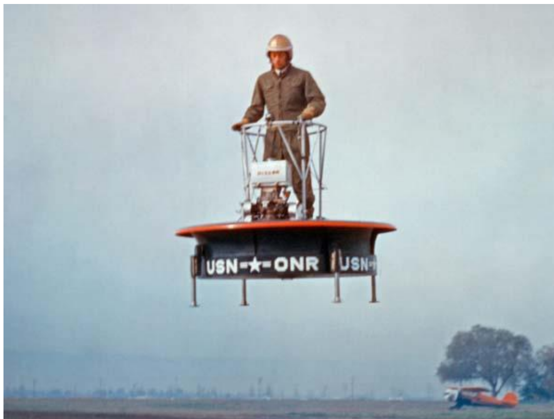
Слика 1.13 Експериментална летелица Hiller Aircraft VZ-1 Pawnee преузето августа 2017. године са: http://www.hiller.org/event/flying-platform/
