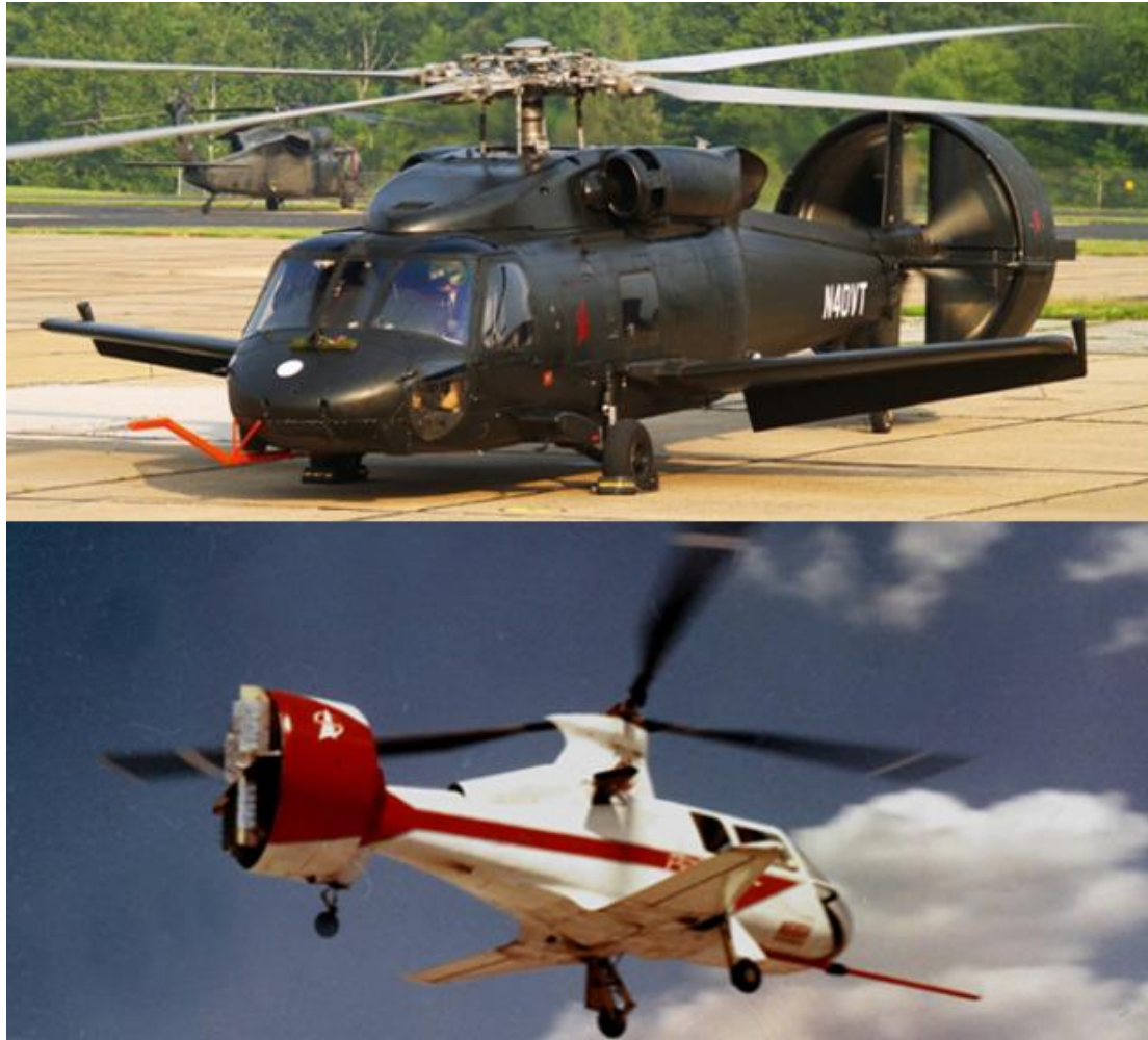
Слика 1.15 Хеликоптери са потисним вентилаторским пропулзором Piasecki X-49 (горе), Piasecki 16H-1 Pathfinder (доле).
