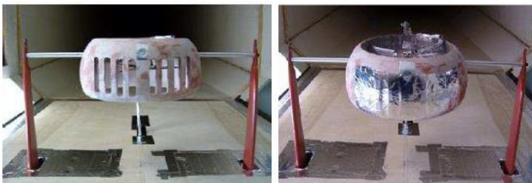
Слика 1.37 Пропулзор са процепима у каналу у аеротунелу [106]
