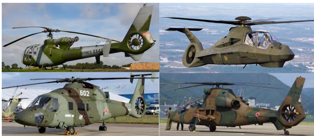
Слика 1.18 Хеликоптери са Fenestron репним ротором Aérospatiale SA 341 Gazelle (горе лево), Камов Ка 60 (доле лево), Boeing Sikorsky RAH66-Comanche (горе десно), Kawasaki OH-1 (доле десно).
