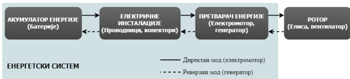
Слика 2.1 Енергетски систем електровентилаторског пропулзора
