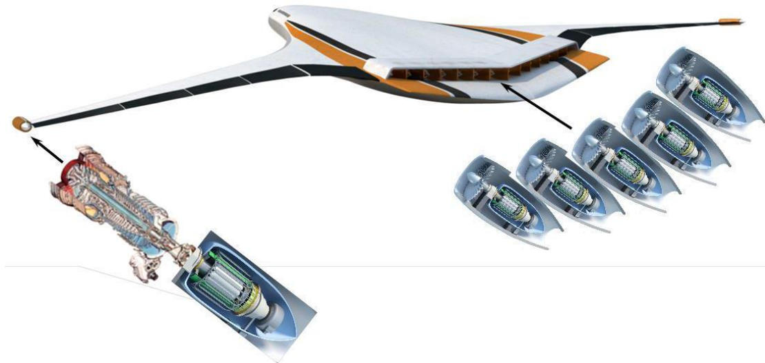
Слика 1.2 Дистрибуирани пропулзивни систем на NASA N3-X [12]
