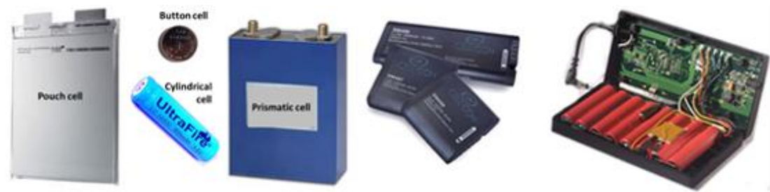
Слика 2.17 Батеријске ћелије и батеријска паковања Типови ћелија батерија (лево) и паковања батерије (десно)
