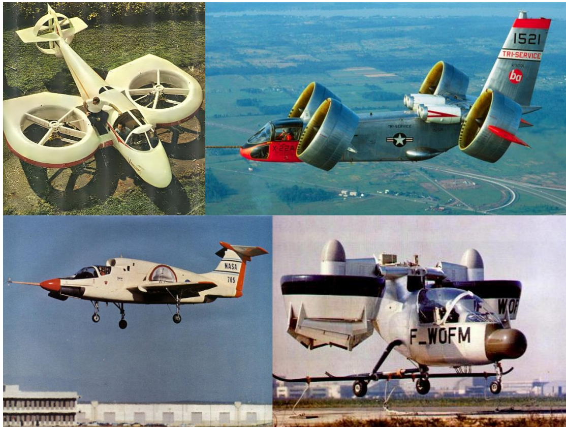
Слика 1.14 Летелице са вертикалним полетањем и слетањем Model 2C Omniplane (горе лево), Ryan XV-5 Vertifan (доле лево), Bell X-22 (горе десно), Nord Cadet 500 (доле десно).
