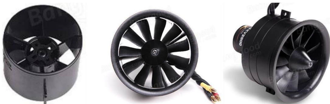
Слика 6.14 Комерцијални електровентилаторски пропулзор
